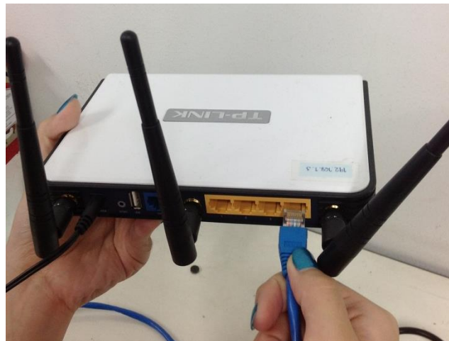
รูปที่ 8.5 การต่อเชื่อมสาย LAN ที่เครื่องแอสเพนพอยต์
