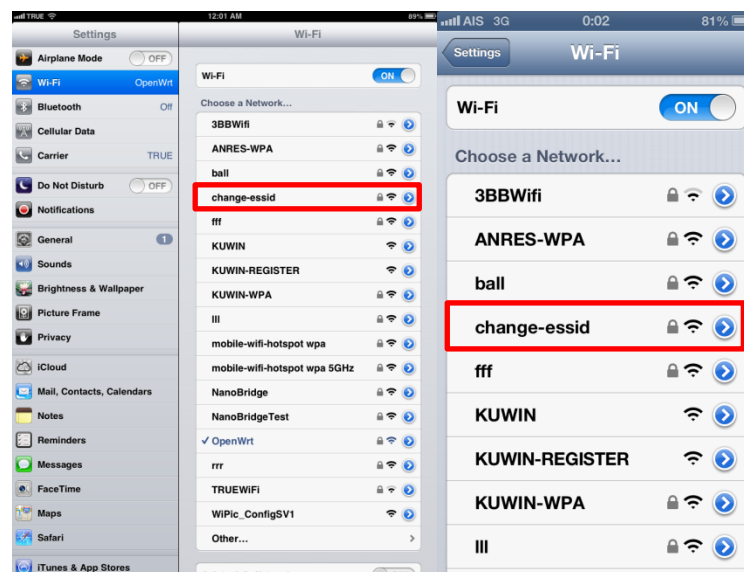
รูปที่ 8.32 ผลลัพธ์การแสดงผลจากเครื่องแท็บเล็ตไอแพด และเครื่องสมาร์ทโฟนไอโฟนตามลำดับ เมื่อแก้ไขชื่อ ESSID ของอินเทอร์เน็ตที่เปิดใช้งานในเครื่องแอดเซสพอยด์
