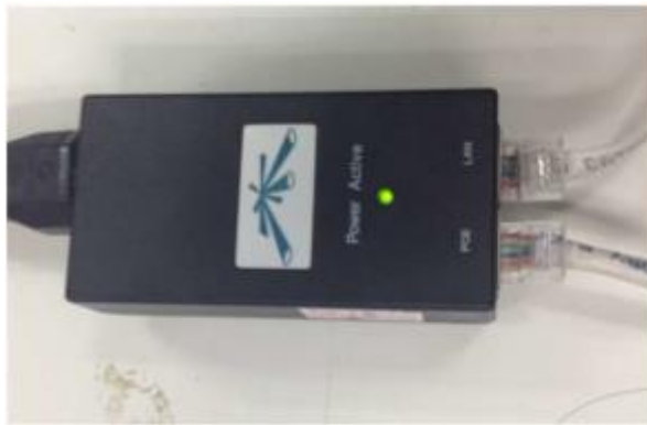
รูปที่ 8.8 การเชื่อมต่อสายแลนกับ PoE Adapter
