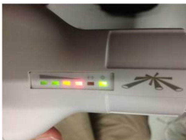
รูปที่ 8.10 ไฟแสดงสถานะความแรงสัญญาณของไวร์เลสแอกเซสพอยต์ติดครบ 4 ดวง
