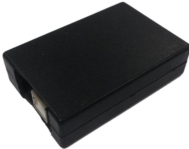
รูปที่ 3.3: เครื่องอ่านรหัส RFID แบบพร้อมใช้งาน
