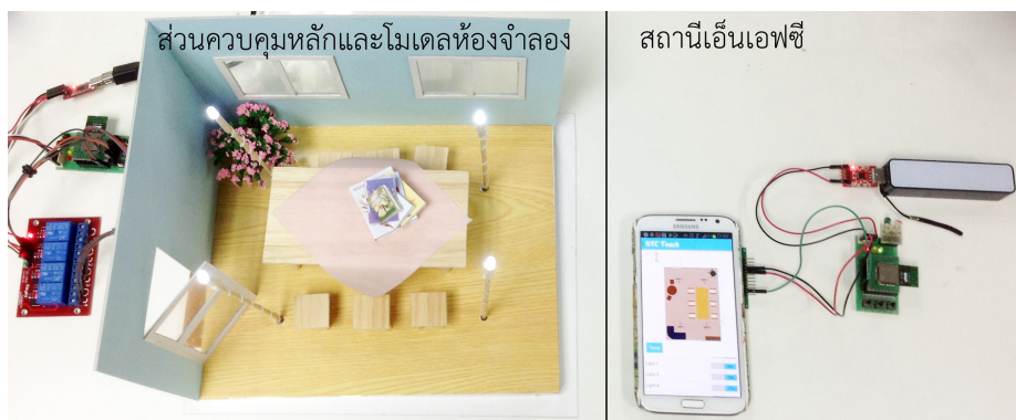
รูปที่ 5.2: สภาพแวดล้อมในการทดสอบควบคุมแบบจำลองห้อง
