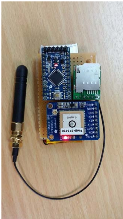
รูปที่ 7.5. การประกอบอุปกรณ์ติดตามสัตว์ป่า(ด้านบน)
