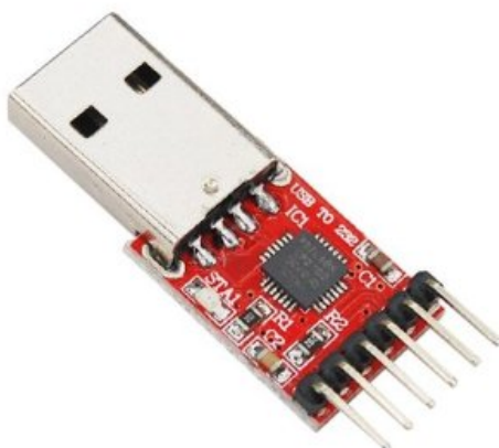
รูปที่ 3.4. USB to UART Bridge [15]
