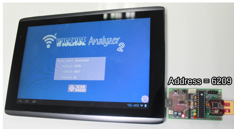
รูปที่ 5.1 การเชื่อมต่อโหนดตรวจสอบเข้ากับแท็บเล็ตแอนดรอยด์
