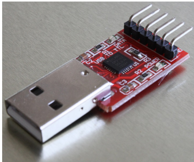
รูปที่ 3.4 CP2102 USB to UART BRIDGE ใช้เชื่อมต่อกับคอมพิวเตอร์
