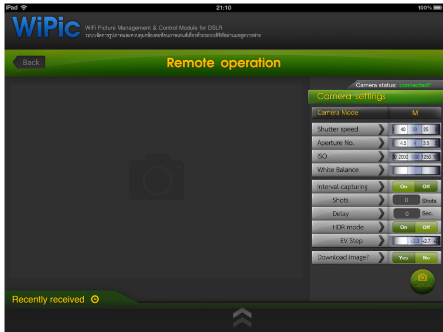
รูปที่ 8.10 วยฟายมอดูลอ่านค่าบนกล้องแล้วส่งกลับมายังไอแพด
