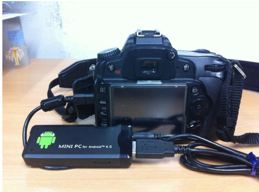
รูปที่ 8.3 การเชื่อมต่อกล้องกับวายฟายมอดูล
