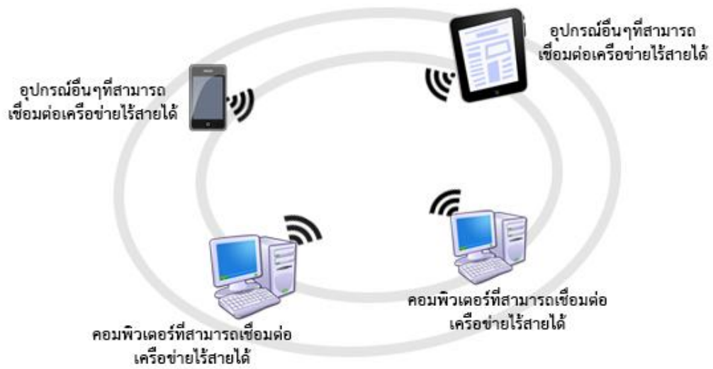
รูปที่ 2.2 โครงสร้างของเครือข่ายไร้สายแบบ ad hoc
