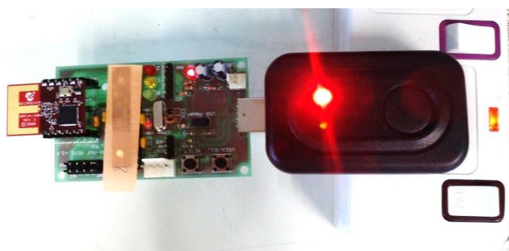
รูปที่ 4.3 โหนดตรวจวัดไร้สายที่ไม่ได้เชื่อมต่อโดยตรงกับอุปกรณ์เกตเวย์
