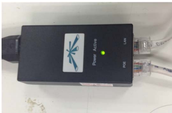
รูปที่ 8.1 การเชื่อมต่อสายแลนกับ PoE Adapter
