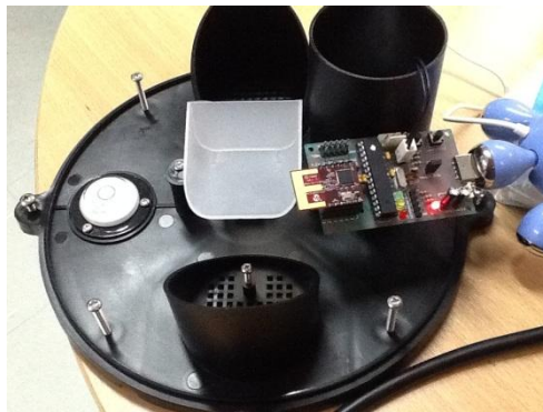
รูปที่ 5.1 โหนดตรวจวัดไร้สาย ที่ติดตั้งอุปกรณ์ตรวจวัดปริมาณน้ำฝน
