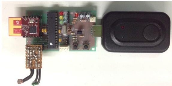
รูปที่ 5.2 โหนดตรวจวัดไร้สาย ที่ติดตั้งอุปกรณ์ตรวจวัดปริมาณน้ำฝน
