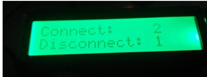
ภาพที่ 5.3 การแสดงผลการเชื่อมต่อของอุปกรณ์ไอโอทีบนจอ LCD
