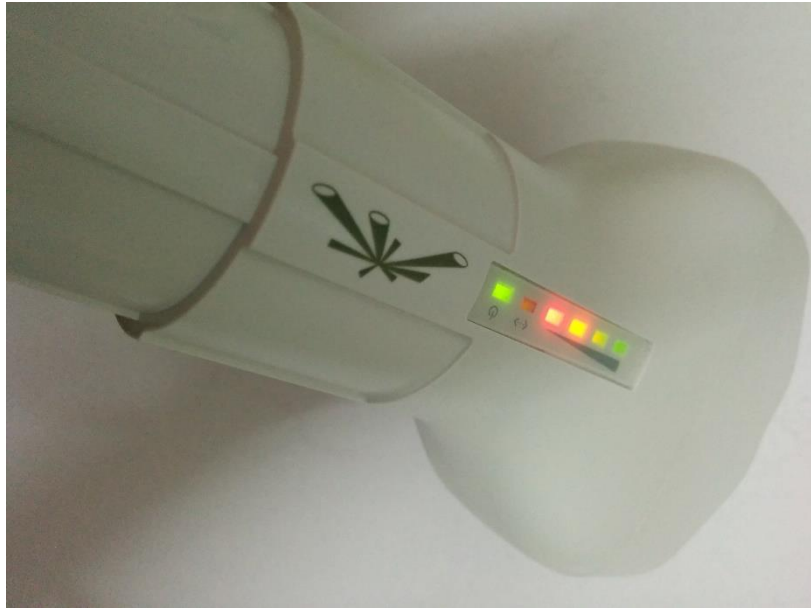
รูปที่ 8.2 ไฟแสดงสถานะบนไวร์เลสแอกเซสพอยต์
