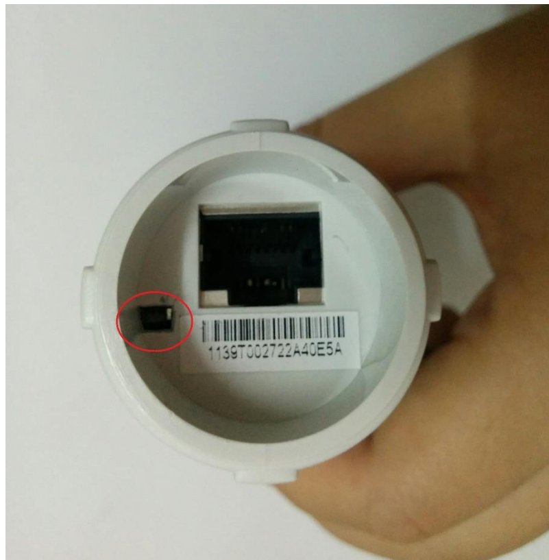
รูปที่ 8.1 ปุ่มรีเซ็ตบนไวร์เลสแอคเซสพอยต์
